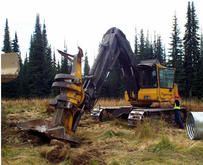
フェラバンチャ（伐倒機） 1本の伐倒作業に要する時間が驚く程短い。切株・木材とも切り口はきれいな平面
