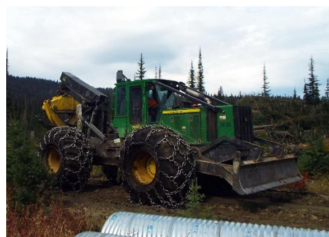
スキッド（集材機） 伐倒された木材を、山土場まで引き出してくる
