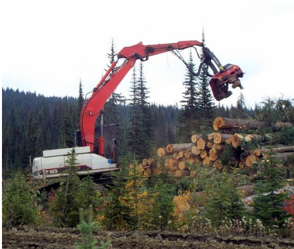
プロセッサ（造材機） 木材をつかみ、横に送りながら枝払い・測尺、所定の長さで玉切り
