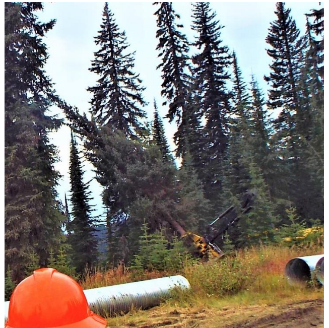
フェラバンチャ（伐倒機） 1本の伐倒作業に要する時間が驚く程短い。切株・木材とも切り口はきれいな平面
