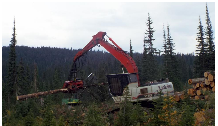
プロセッサ（造材機） 木材をつかみ、横に送りながら枝払い・測尺、所定の長さで玉切り
