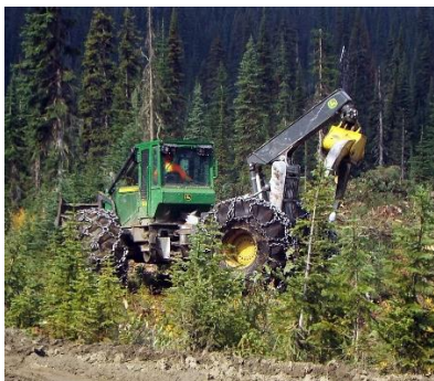
スキッド（集材機） 伐倒された木材を、山土場まで引き出してくる
